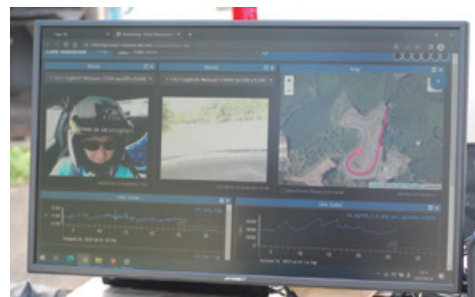
リアルタイム計測画面 車載カメラ映像、位置情報、車載センサ情報をリアルタイムに表示
