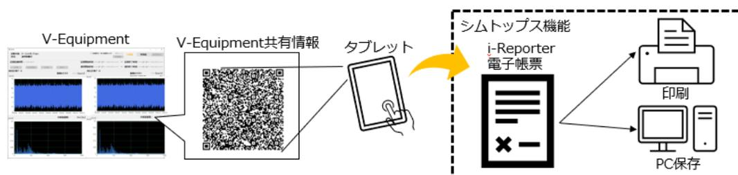
設備の振動計測・解析結果 → タブレットへ自動入力 → 電子帳票作成
